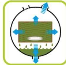
4 - Extraction du produit en excès avec aussi mise en bascule de la palette.
