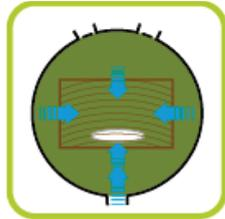
3- Mise sous pression hydraulique de 10 bars.
