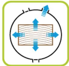
1 - Installation de la palette complète de votre kit dans le tunnel appelé autoclave puis extraction sous vide de l'air s'y trouvant.
