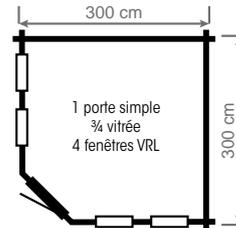
Porte d'angle, supportée par 2 profiles robustes (150 x 100 mm)
