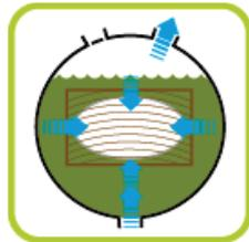
2 - Remplissage sous vide du tube avec la solution : THANALITH E3475
